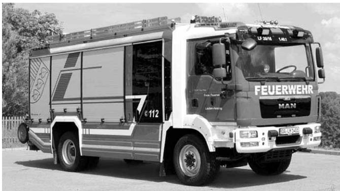
Aufgebaut wurde das LF 20/16 von der Firma Rosenbauer aus Leonding (Österreich). Als Fahrgestell wurde ein MAN TGM 15.290 4x4 mit 290 PS und automatisiertem Schaltgetriebe gewählt. Mit seinem Einsatzgewicht von 15 t entspricht das Fahrzeug der Norm. Dieses Fahrzeug ist das Standardfahrzeug bei deutschen Feuerwehren und ist für den Ersteinsatz bei Brandbekämpfung, technischer Hilfeleistung und zur Menschenrettung konzipiert. Für die Brandbekämpfung steht eine
